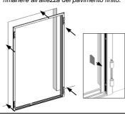
**4.3.-** Avvitare il telaio al muro rispettando le distanze di cui al punto 12. Utilizzare tasselli metallici ad espansione Ø 10 e 120 mm.
