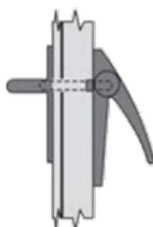
Possibilità di apertura esteriore mediante maniglia.
