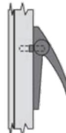
Mecanismo de ante passiva, senza accionamento esteriore .
