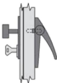
Possibilità di apertura esteriore mediante chiave con pomo fisso.
