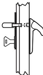
Possibilità di apertura esteriore mediante maniglia e chiave.
