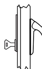
Possibilità di apertura esteriore mediante chiave.
