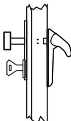
Possibilità di apertura esteriore mediante chiave con pomo fisso.
