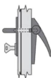
Possibilità di apertura esteriore mediante maniglia e chiave.
